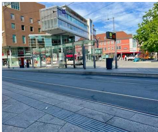
Anger Straßenbahnhaltestelle – Wartehalle und Blindenleitsystem
