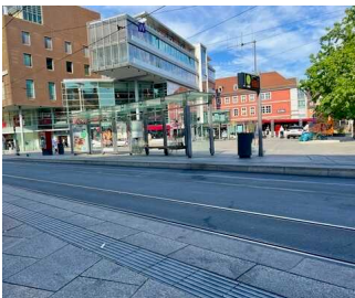
Anger Straßenbahnhaltestelle – Wartehalle und Blindenleitsystem
